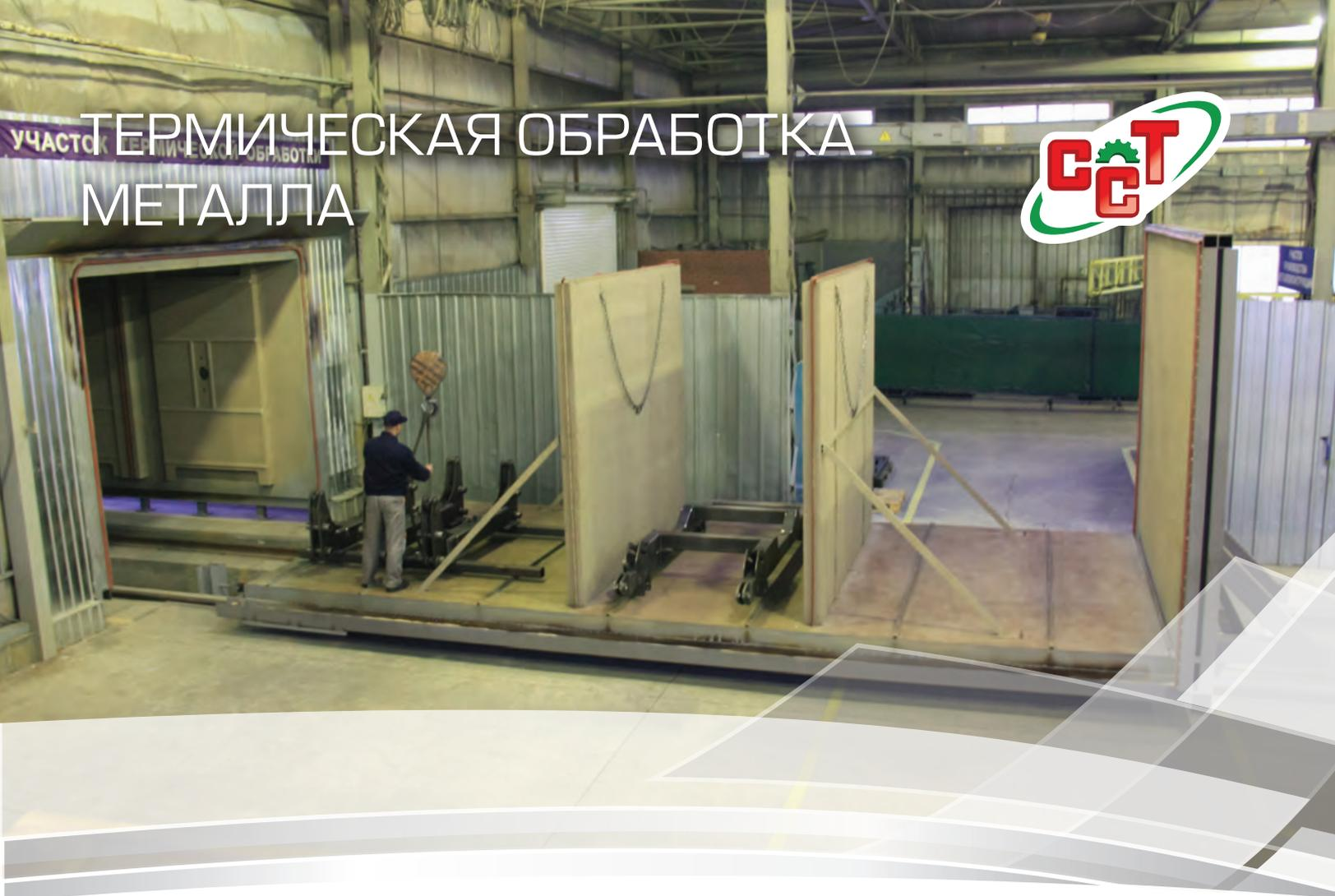
Трехсекционная камера для термического отпуска металла.
