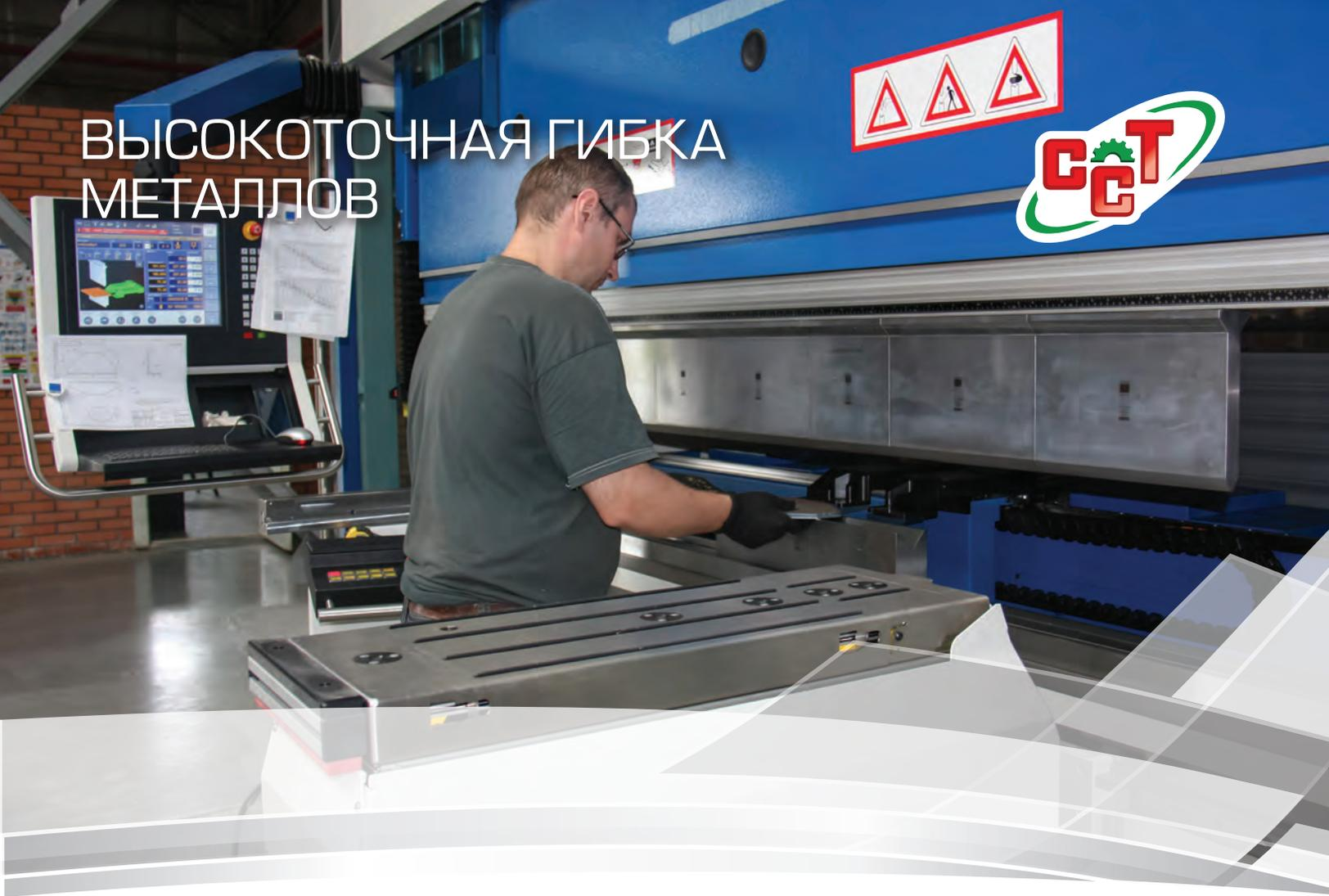
Кромкогибочный пресс фирмы «Trumpf» (Германия) для свободной гибки и фальцевания.
